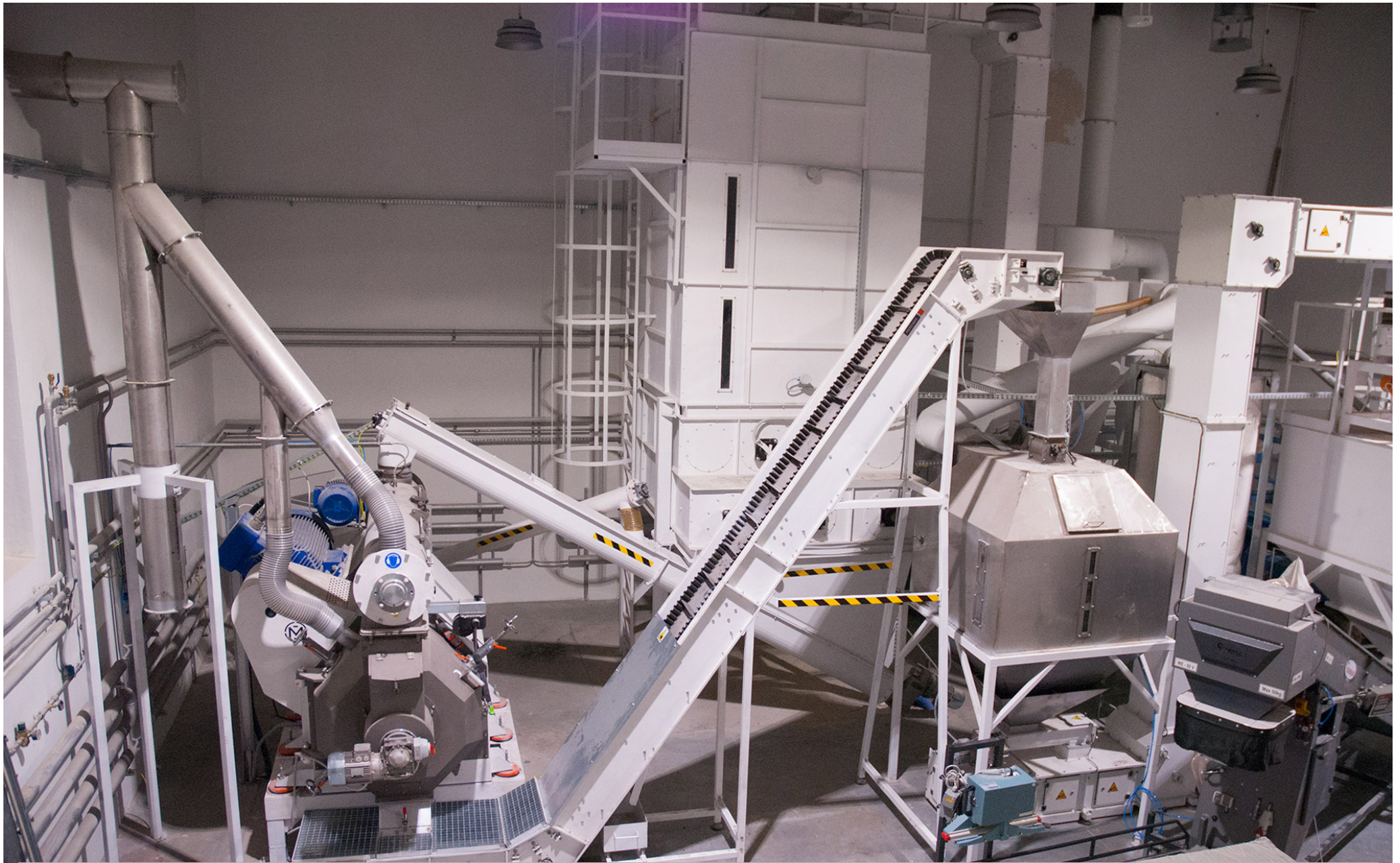
ZBIORNIK SUROWCA 30M 3 Z WYBIERAKAMI ŚLIMAKOWYMI I KUBEŁKIEM TYPU Z
