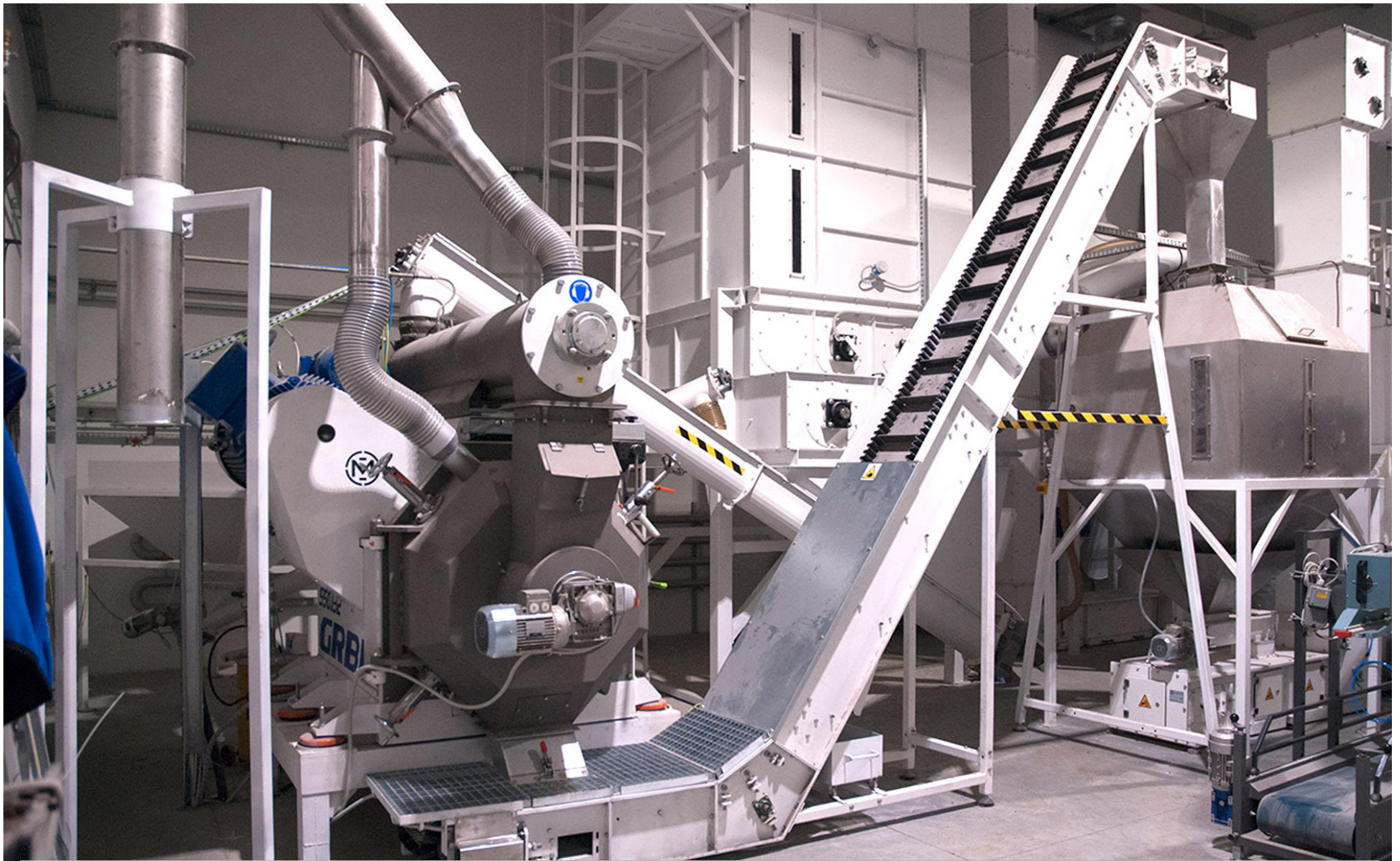
GRANULATOR GRB1 550.132 W WERSJI KWASOODPORNEJ DLA WIORÓW DĘBOWYCH
