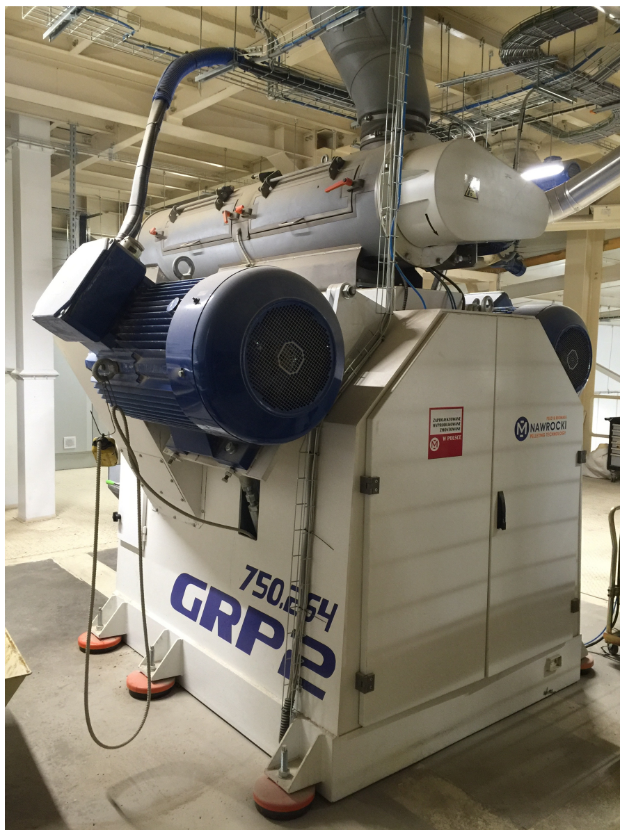
GRP2 750.264 z ocieplonym kondycjonerem i zespołem stabilizacji pary
